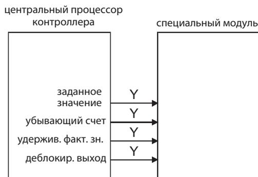
Выходы для управления специальным модулем в программе коммутируются точно так же, как и другие выходы (например, с помощью команд SET, RST или OUT).
